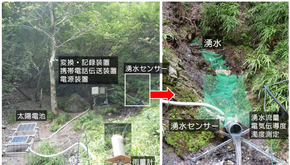
図2-3 湧水センサーの設置状況
